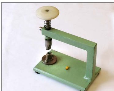
Dispositivo di chiusura nell'incastonatura di pietre piu' grandi
