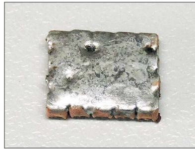
Materiale di saldatura applicato al prodotto in anticipo e riscaldamento di tutta la superficie del prodotto
