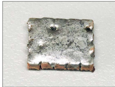
Quantità eccessiva del materiale di saldatura (rischio di penetrazione del materiale fuso dentro i castoni)
