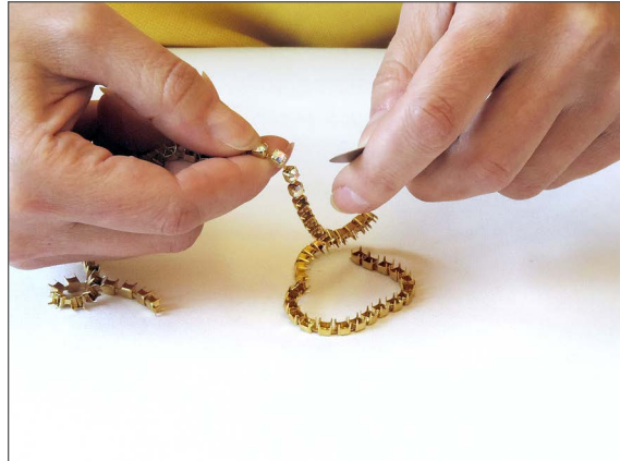
Chiusura a mano delle griffe del castone
