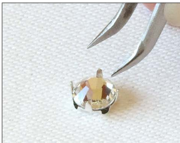
Chiusura a mano delle griffe, usando la pinza
